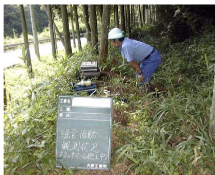
写真 3.2-3 騒音レベルの測定状況
