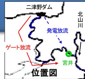
濁度が高い場合、**発電放流**と**ゲート放流**の濁度に大きな差はない
