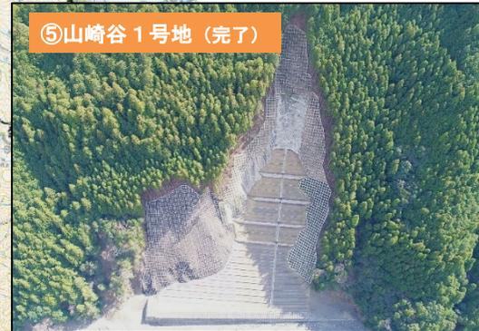
山腹工(法枠工・モルタル吹付工・緑化工)
