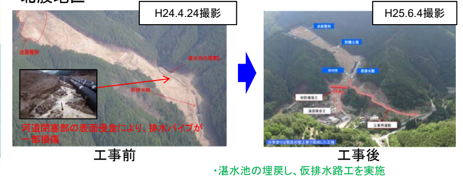
河道閉塞の復旧状況(緊急対策工事完成時点)
