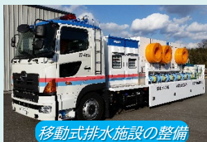
移動式排水施設の整備
