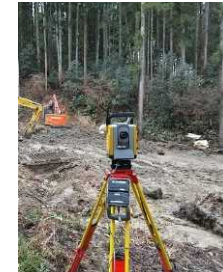
レーザスキャナを用いた3次元起工測量
