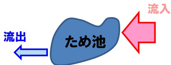
ため池の放流口を小さくする(オリフィスの設置)ことで、ピーク時の流出量を低減し、下流域への洪水到達時間を遅らせる
