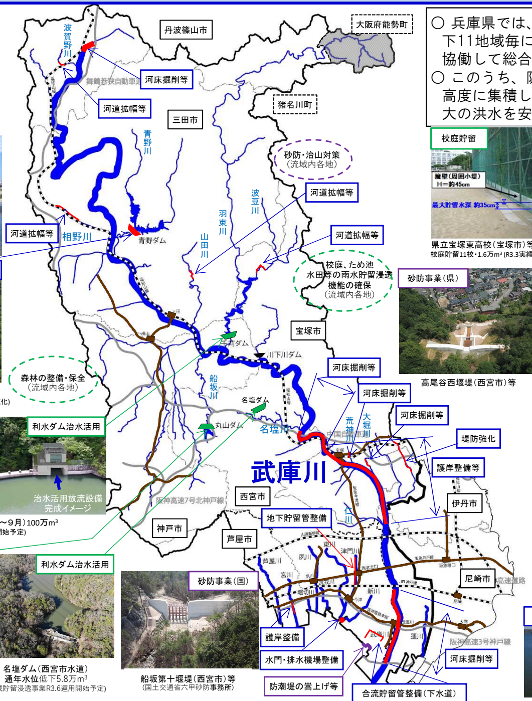
青野ダム(多目的) 事前放流40万 m^3 (H21.2 20万 m^3 運用開始・R2.6容量拡大・今後予備放流化)
