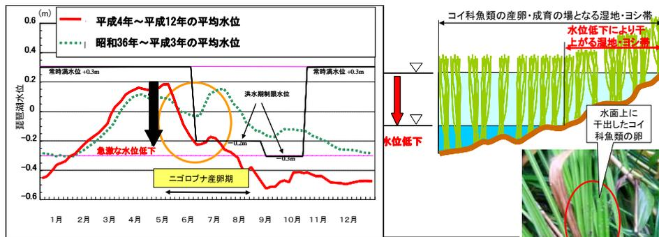
急激な水位低下により湿地・ヨシ帯が短期間に干上がり、卵が死滅
