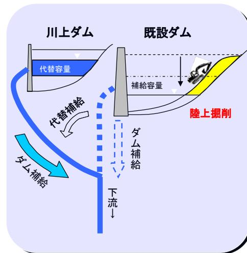
木津川上流の既設ダムから下流へ補給するための容量を、川上ダムに代替容量として確保し、代替補給することにより、既設ダムで水位低下させ、陸上掘削を実施
