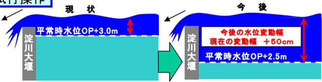
水位変動や攪乱の増大を図り川のダイナミズムを再生させるために、できるだけ自然流況に近い流量が流れるようダム・堰等の運用を試行する。
