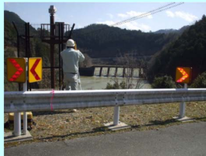
世木ダム堤体の変位計測
