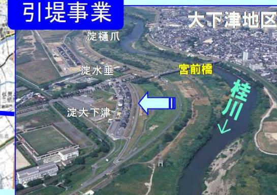
● 今回の台風18号の洪水時の水位を、掘削がないとした場合の計算水位と比較すると約0.3mの水位低下の効果が見込まれ、掘削済区間においてはピーク時の水位を計画高水位以下におさえることができた。また、上流の越水地点においては0.1m程度の水位低下効果があったと見込まれる。
