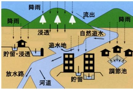
総合治水対策では、河川改修を進めると共に、雨が降った流域で、雨水を一時的にためる施設をつくるなどして洪水を防ぐこととし、建物のピロティ化や都市部の調整池等を行っており、猪名川河川事務所の地下には雨水貯留槽を設け、河川への流出を抑制する対策を行っている。
