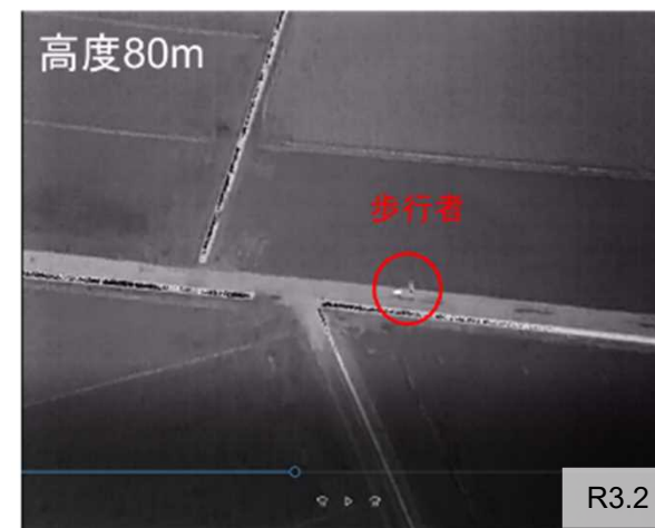
課題対策に向けた取り組み <赤外線カメラ搭載ドローンによる人の検出効果検証>
