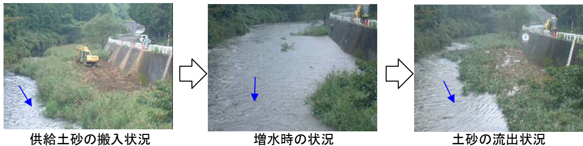
写真 4.2.5-5 布目ダム下流土砂供給試験状況
