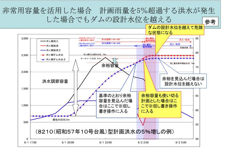
※但し書き操作:計画の洪水調節操作から、洪水調節量を減らしながら流入=放流の操作に移行する操作。 ゲート操作にはある程度の時間が掛かるため、その間もダムの水位は上昇する。
