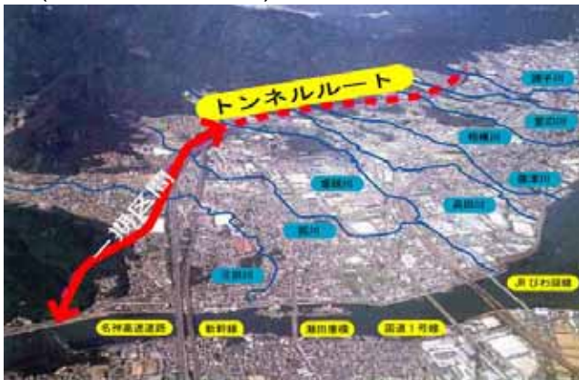
写真 4.3.3-5 大津放水路と流入河川
