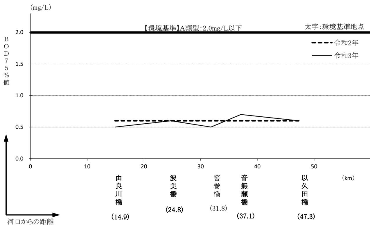
図-1.54 由良川の水質縦断面図（BOD75%値）
