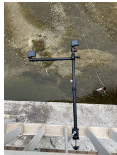
マルチスペクトル カメラによるワンドの撮影 橋からワンドを撮影している様子
