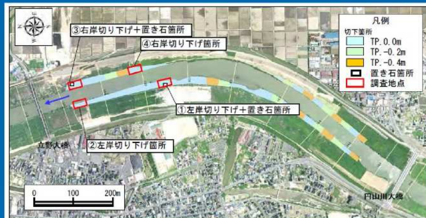
図 2. 3. 3 底生動物調査(高水敷き切り下げ箇所)の調査地点及び調査箇所
