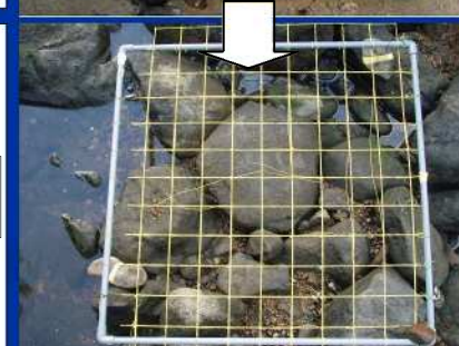
室生ダム下流における河床材料の変化の例 (土砂供給地点より約100m下流地点)
