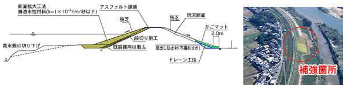
図 6.1-4 木津川堤防強化断面の例
