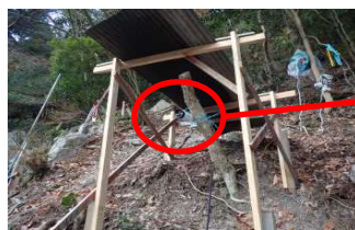
写真1 カメラ設置 簡易屋根を設置し、小規模の倒木から保護。
