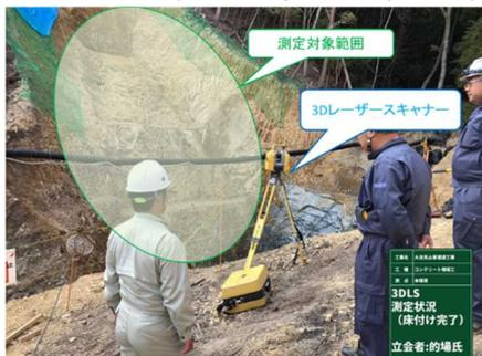
写真-2.3Dレーザースキャナー測定状況
