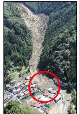
崩壊土砂が河道閉塞引き起こし集落の一部が浸水
