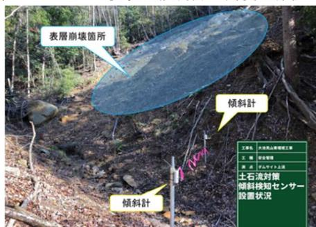
写真-3.表層崩壊及び傾斜計設置状況
