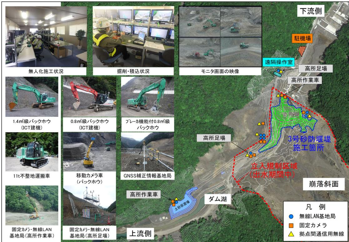
図-5 無人化施工設備配置図
