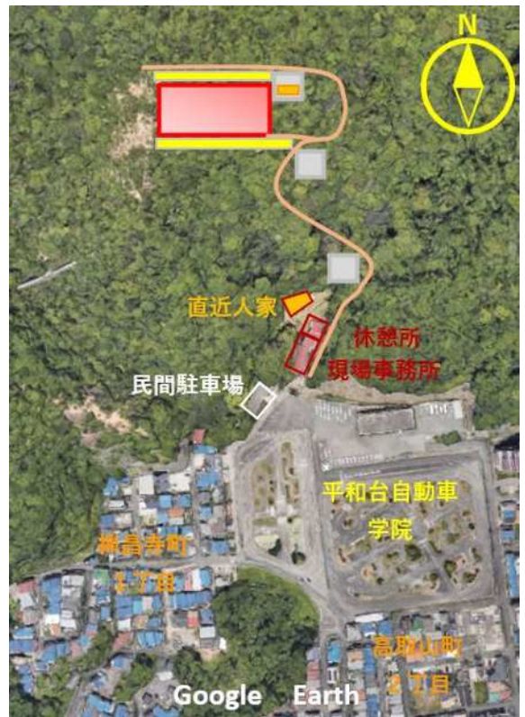
■ 施工箇所 ■ 通路 ■ ステージ ■ 注入プラント ■ モノレール
