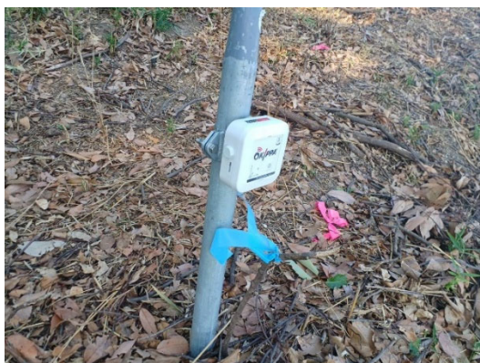
図-13 傾斜監視クラウドシステム設置状況
