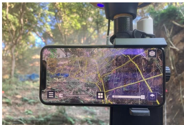
■写真-6 ARを活用した ワイヤー連結工の割付状況
