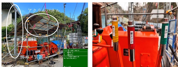
写真－2 (左)排ガス装置 (右)レバー識別
