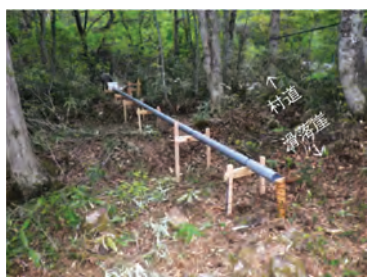
伸縮計 S-1 携帯回線で事務所等へ24時間配信 (10分間隔、電源はソーラーパネル)
