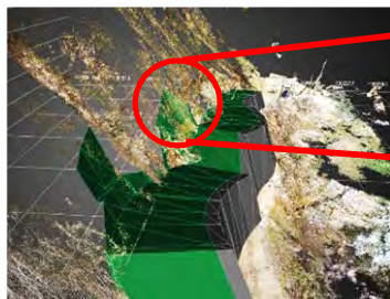
補強土壁の 3D モデル
