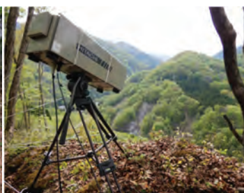
監視カメラ(Ku-SAT) 衛星回線で事務所等へ24時間配信 (リアルタイム、電源は発電機)
