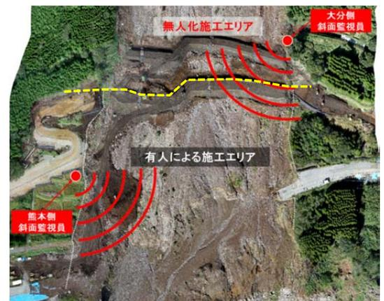
写真-15 有人施工エリアと斜面監視体制
