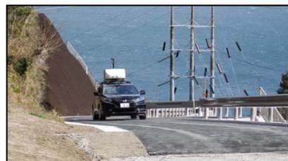
写真 3 MMS による出来形計測状況
