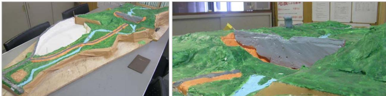
模型は平面図から数字を拾い 1/300 のスケールで作成し、着色することで実際の現場に近い形状の物を作ることができました。
