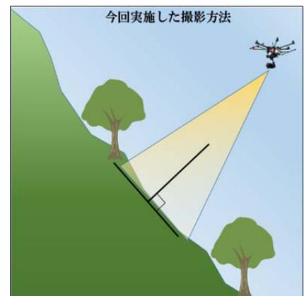
図8 カメラを斜面に垂直に操作
