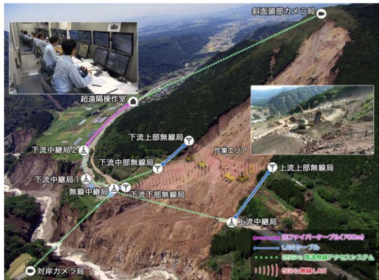
図-2 ネットワーク型無人化施工システムの概念図
