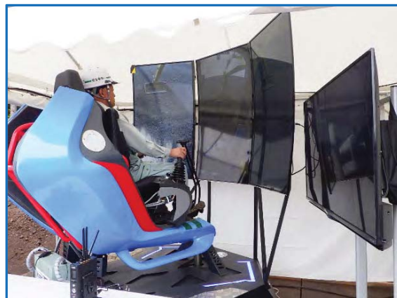
写真-4 遠隔操作コックピット
