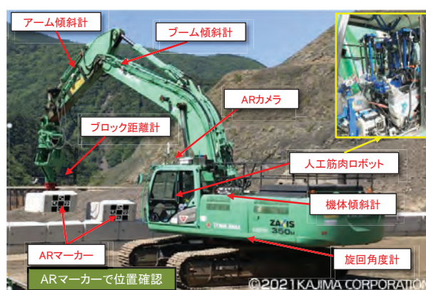
図-8 自動化仕様バックホウ概要図
