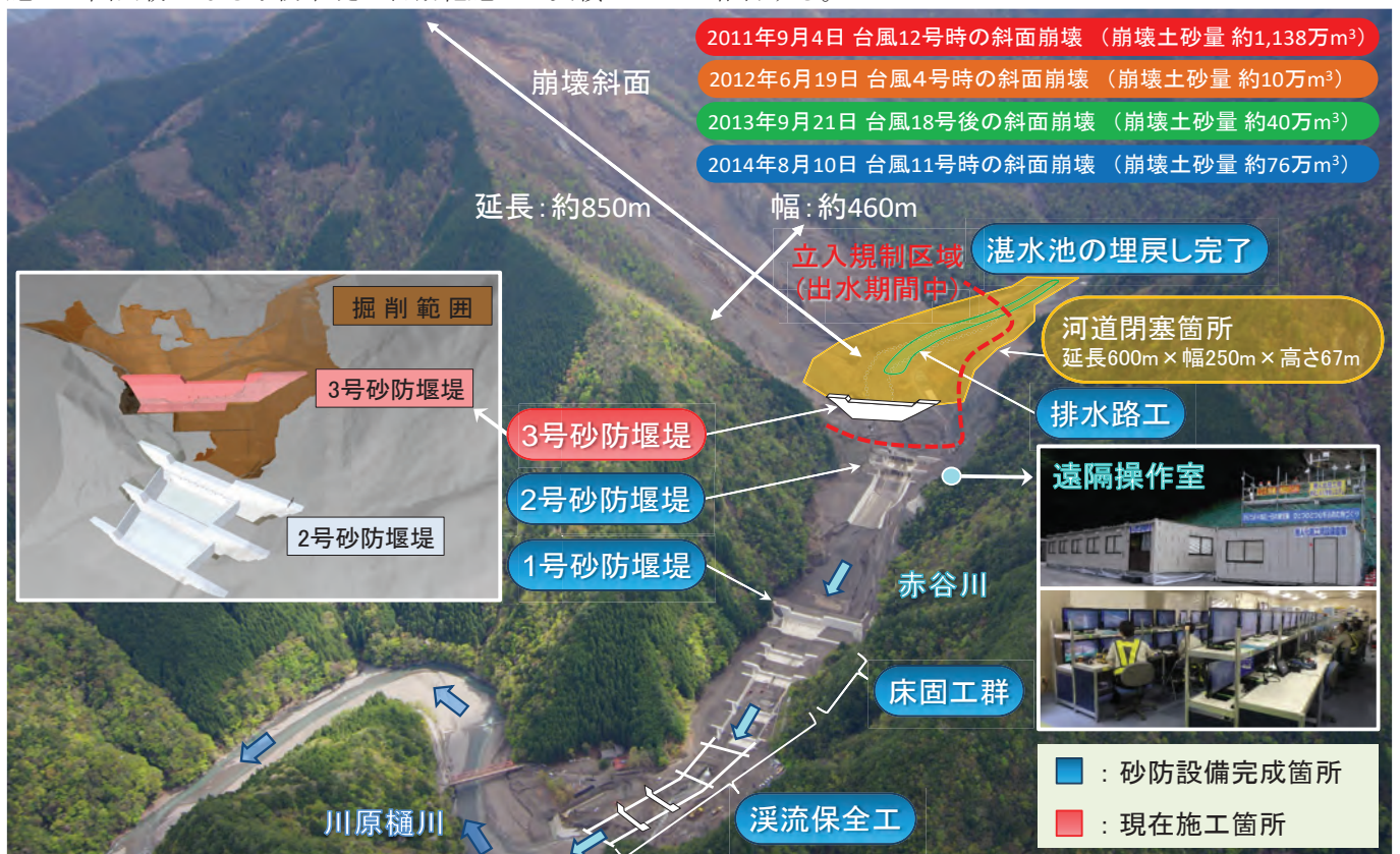
図-2 赤谷地区対策工事全体概要図
