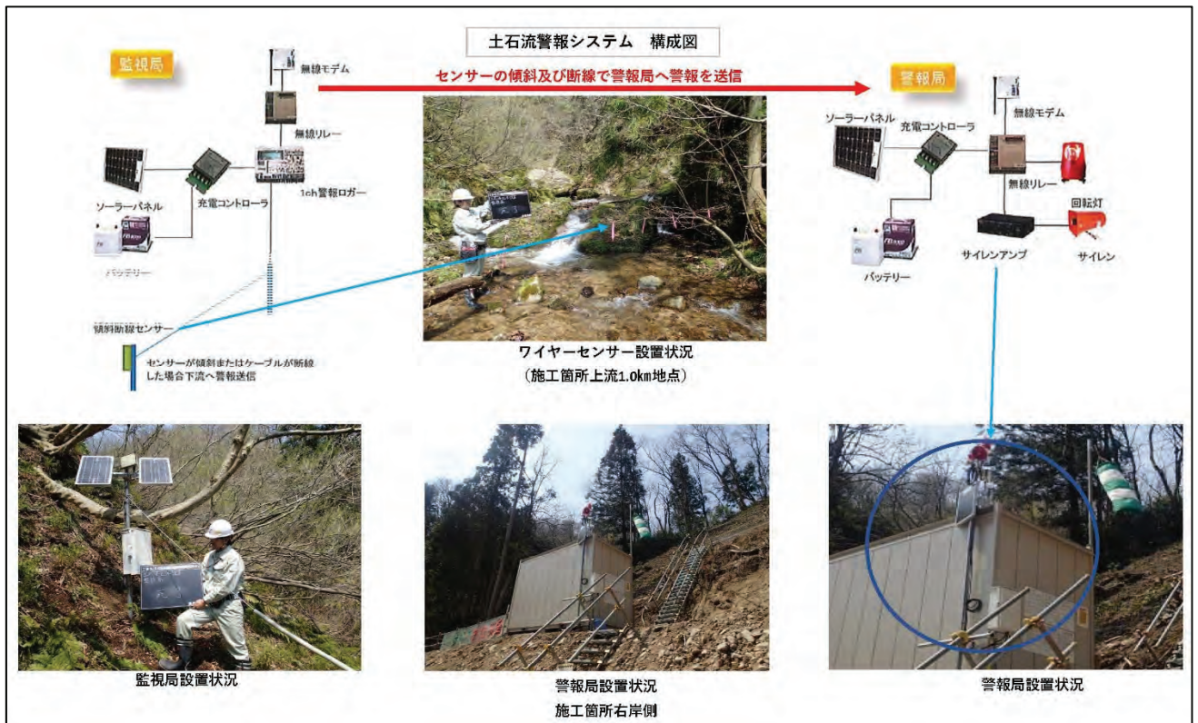
図-2 土石流警報システム構成図
