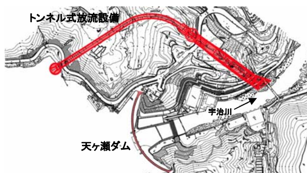
図 4.3.2-19 天ヶ瀬ダム再開発による放流能力の増強
