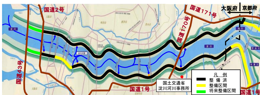
図 4.3.4-1 緊急用河川敷道路整備区間
