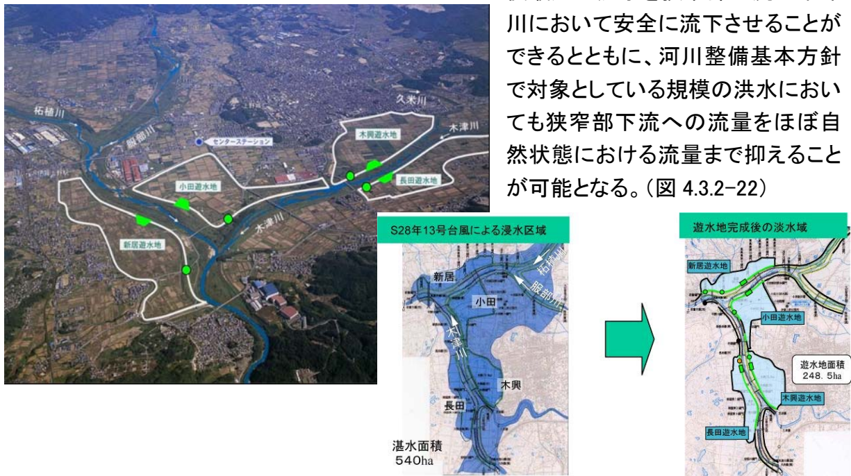
図 4.3.2-22 上野地区の浸水被害軽減を図る上野遊水地
