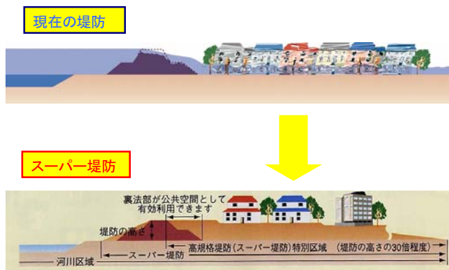
図 4.3.2-27 高規格堤防の整備イメージ
