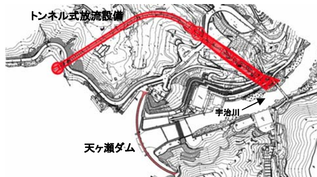
図 4.3.2-19 天ヶ瀬ダム再開発による放流能力の増強
