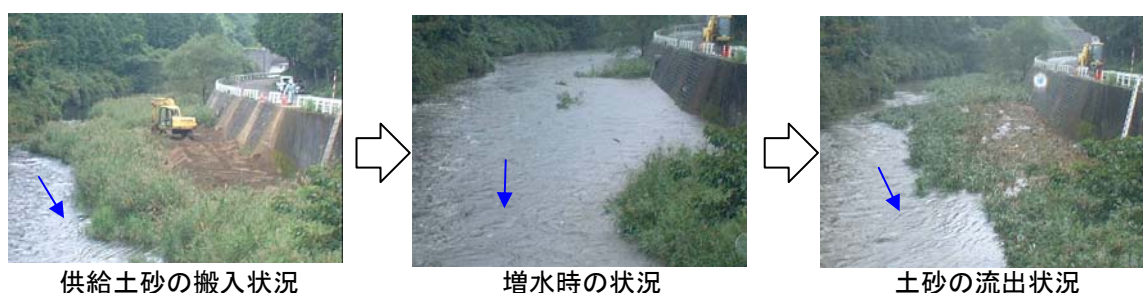
写真 4.2.5-5 布目ダム下流土砂供給試験状況
