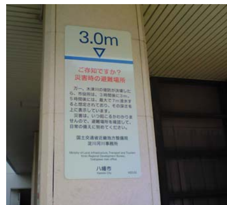
写真 4.3.2-3 洪水標識板(八幡市の事例)
