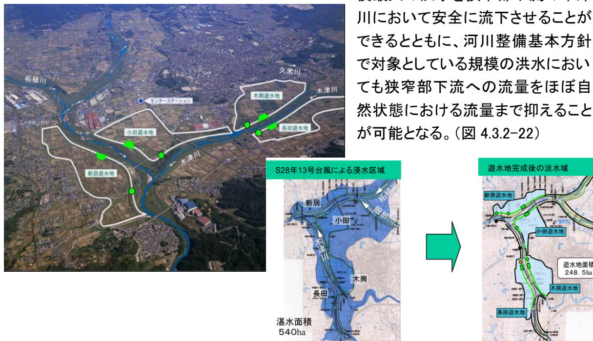
図 4.3.2-22 上野地区の浸水被害軽減を図る上野遊水地
