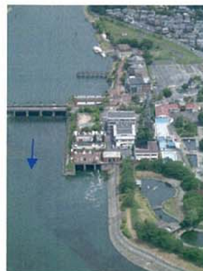
写真 4.3.2-8 瀬田川洗堰のバイパス水路 (写真 4.3.2-8)
