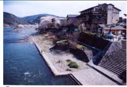
⑬ 大きく河道を狭められた川。2つの水制は壊され、砂洲は消滅。
