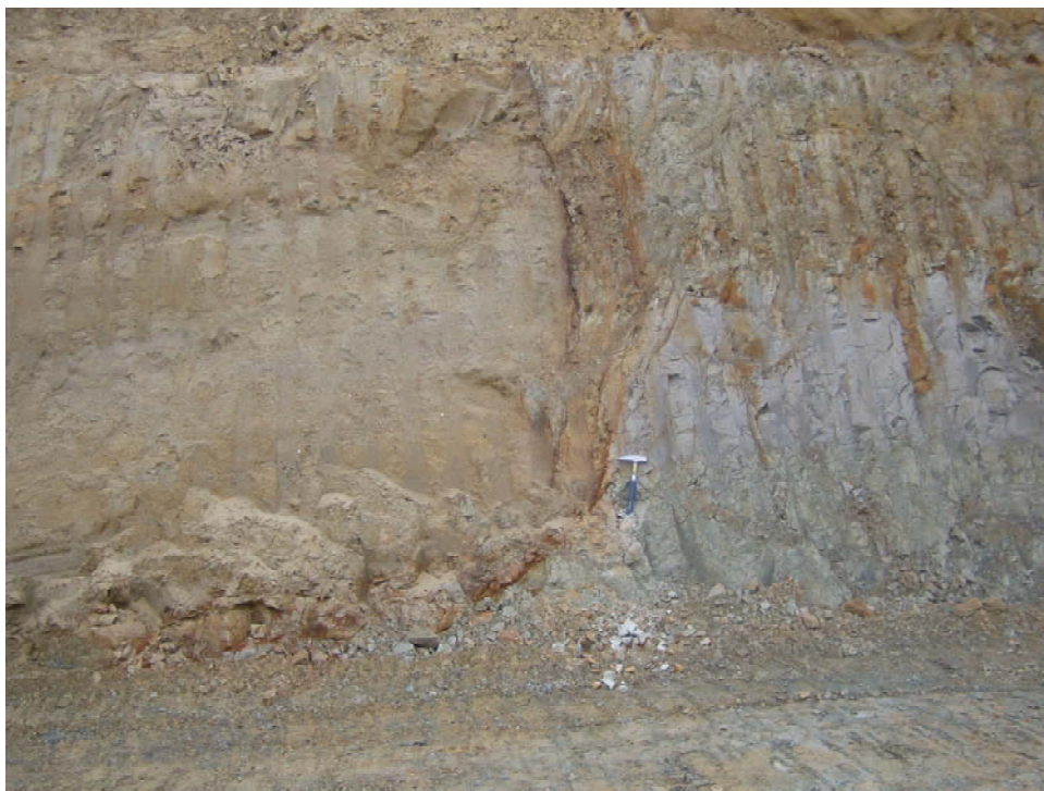
写真1 明星団地周辺の大坂層群を切る活断層露頭 走向・傾斜は EW、ほぼ直立
