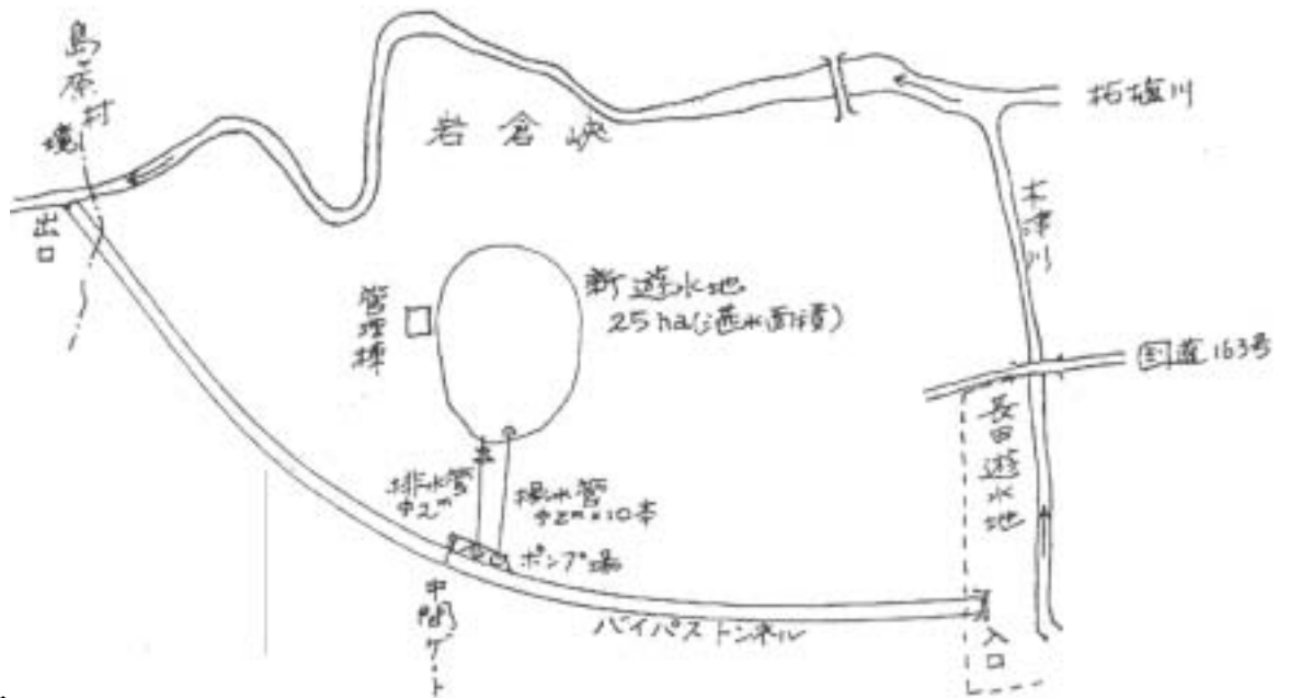
D-2 岩倉峡遊水地付バイパストンネル
