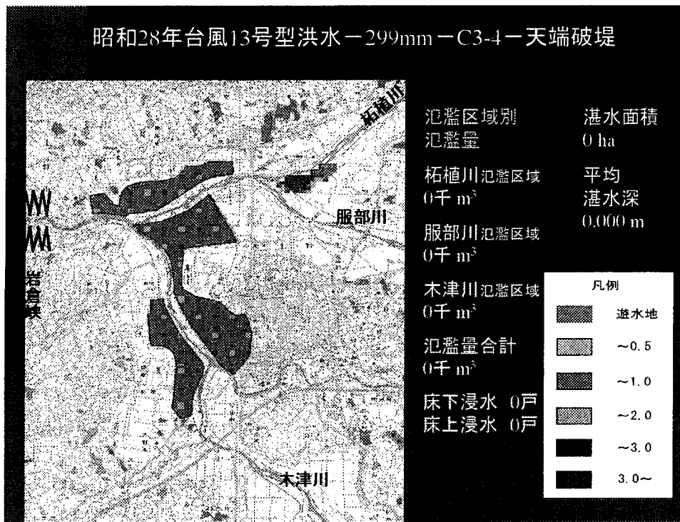
図 2-3 現況河道での氾濫計算結果（昭和 28 年台風 13 号型洪水）
