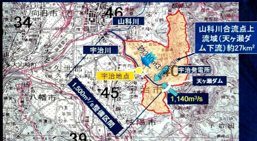
天ヶ瀬ダム再開発後の計画最大放流量 $1,140\text{m}^3/\text{s}$ +宇治発電所放流量約 $60\text{m}^3/\text{s}$
