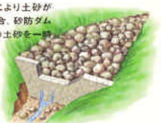
④ 一時的に砂防ダムに貯められた余分な土砂は、その後の川の流れによって徐々に下流へ流れ出され、②の状態に戻ります。
