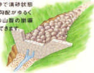
③ 大雨などにより土砂が流れてきた場合、砂防ダムはさらに多くの土砂を一時的に貯めます。
