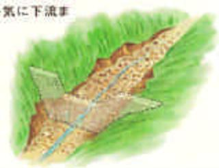
② 砂防ダムを造ると、上流からの土砂で清砂状態になり、川の勾配がゆるくなって両岸の山麓の崩壊を防ぐことができます。
