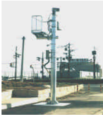
河川監視用カメラ装置
