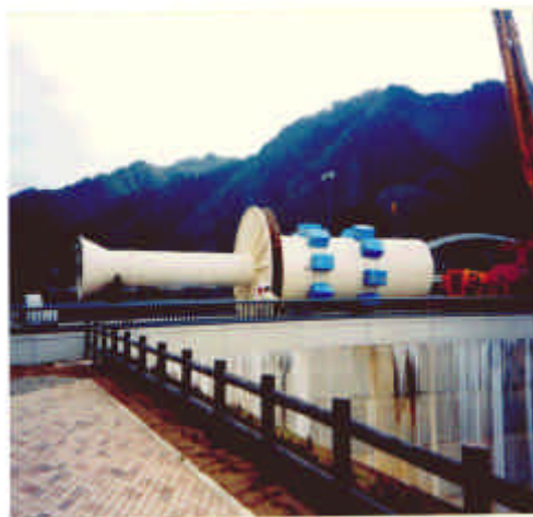
深層曝気設備(設置前)
