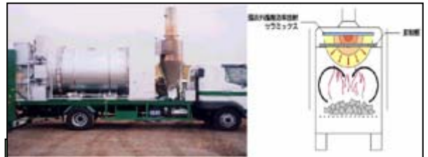
移動式焼却車(ダイオキシン抑制型焼却炉)
