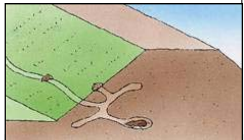
モグラによる堤防法面の損傷事例
