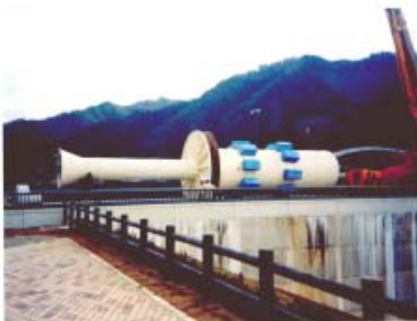
深層曝気設備の事例(設置前)
