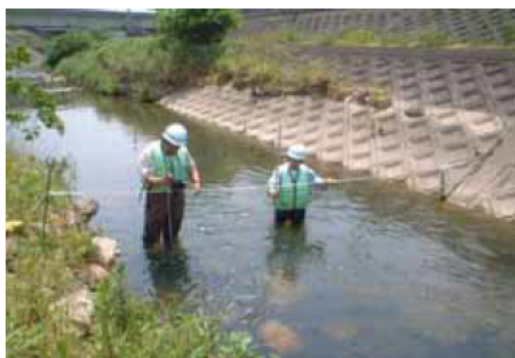
↑ 流量観測の状況
