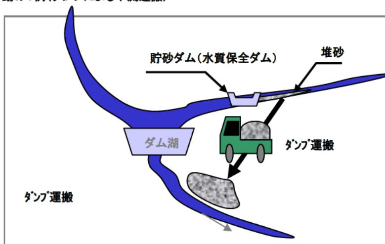
土砂を貯砂ダム(水質保全ダム)によってダム湖に流れ込む前に貯めた後取り除き、ダンプで下流へ運ぶ。
