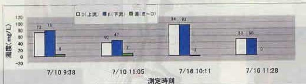
図-8 工事用道路(中河内工区)の濁度測定2(H14.7/10, 7/16)
