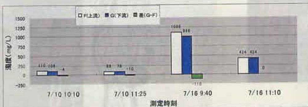
図-9 工事用道路2号線の濁度測定 (H14.7/10, 7/16)
