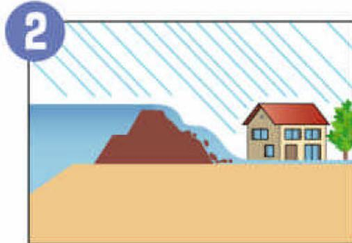
河川の水が堤防を越え、街側の堤防がくずれはじめる。
