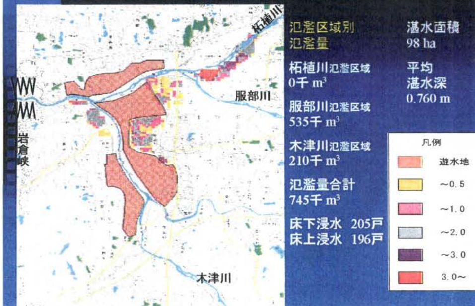
図 2-12 河床掘削後の氾濫計算結果 (昭和 40 年台風 24 号型洪水)
