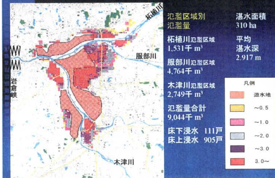
図 2-8 河床掘削後の氾濫計算結果 (昭和 40 年台風 24 号型洪水)
