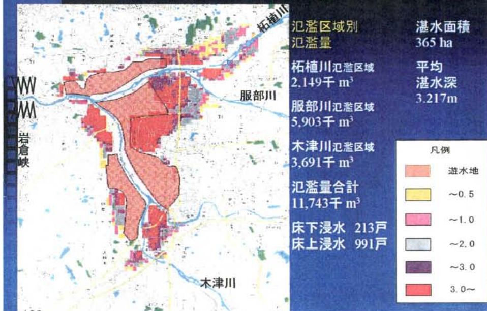
図 3-8 河床掘削後の氾濫計算結果 (昭和 40 年台風 24 号型洪水)
