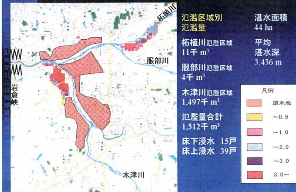
図 2-10 河床掘削後の氾濫計算結果（昭和 40 年台風 24 号型洪水）
