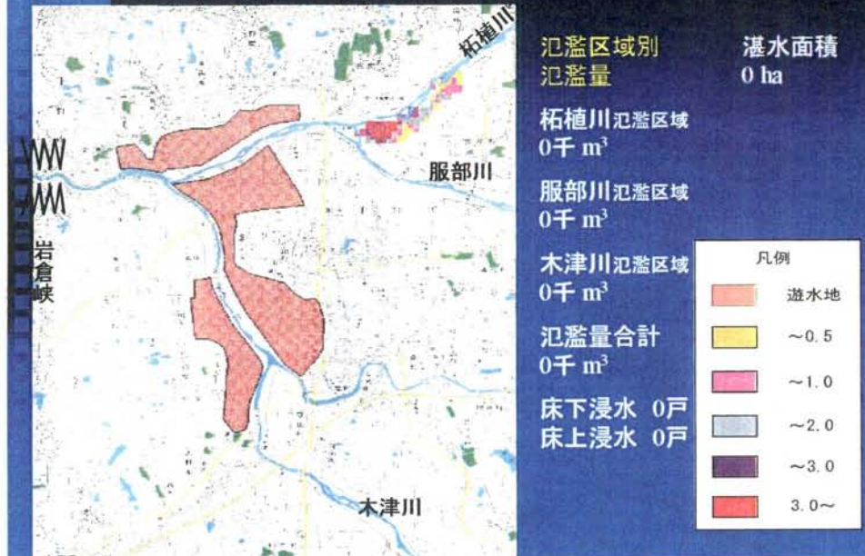
図 3-3 現況河道での氾濫計算結果 (昭和 28 年台風 13 号型洪水)
