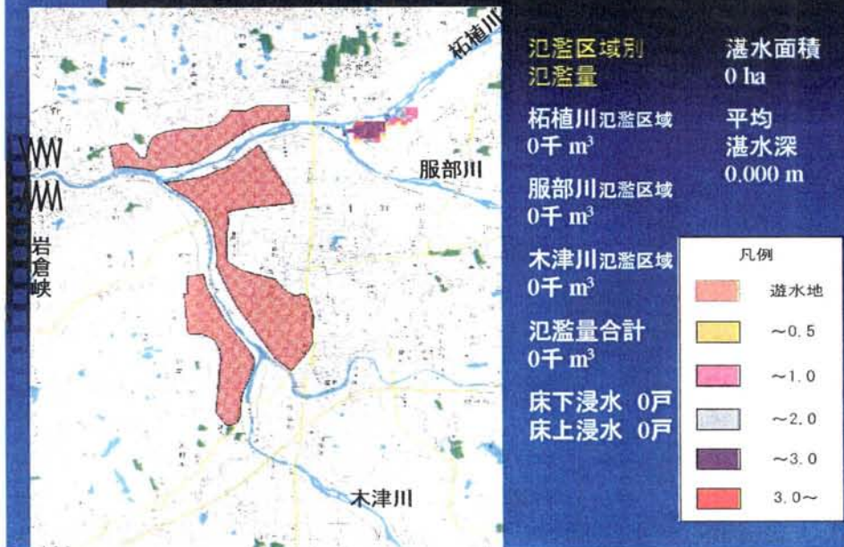
図 2-6 河床掘削後の氾濫計算結果（昭和 28 年台風 13 号型洪水）
