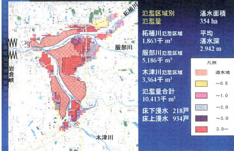
図 2-7 現況河道での氾濫計算結果 (昭和 40 年台風 24 号型洪水)
