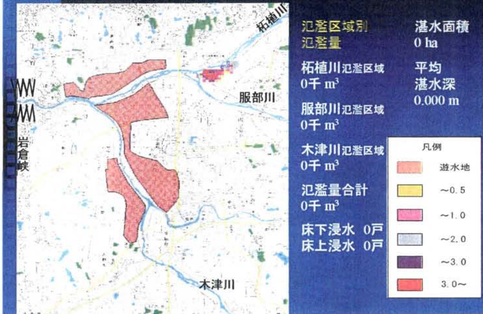
図 2-5 現況河道での氾濫計算結果（昭和 28 年台風 13 号型洪水）
