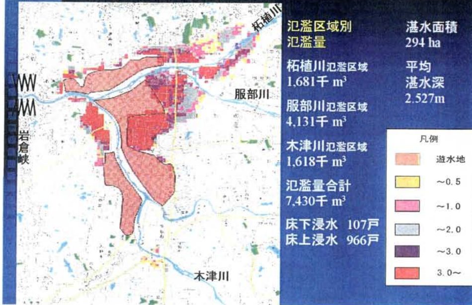
図 3-9 現況河道での氾濫計算結果 (昭和 40 年台風 24 号型洪水)
