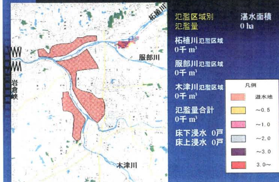
図 3-4 河床掘削後の氾濫計算結果 (昭和 28 年台風 13 号型洪水)
