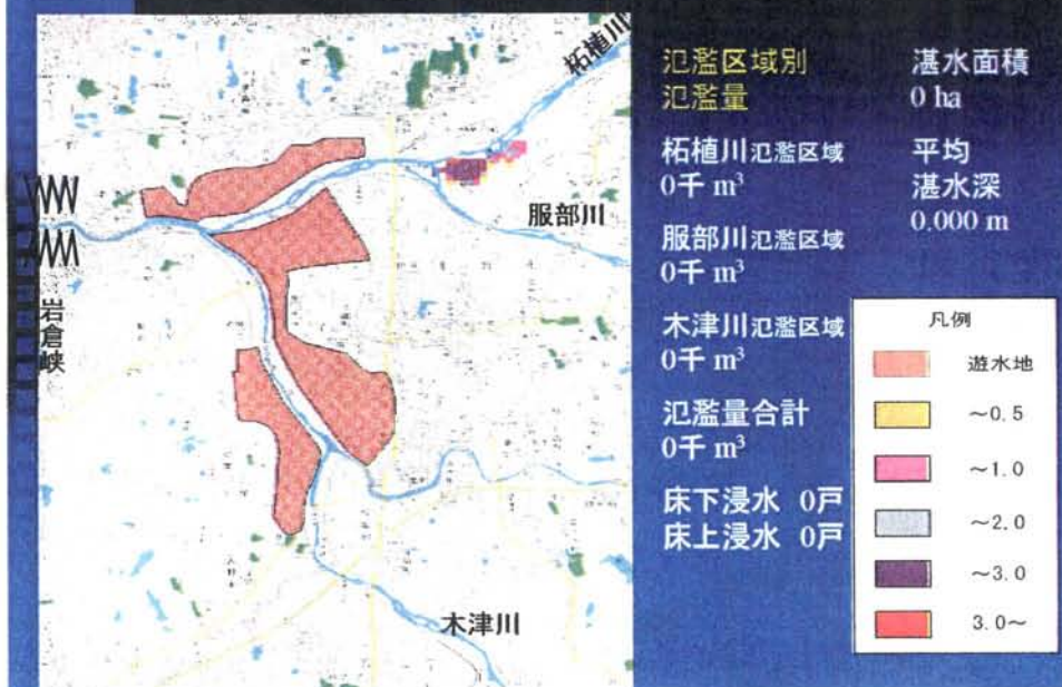
図 2-4 河床掘削後の氾濫計算結果（昭和 28 年台風 13 号型洪水）
