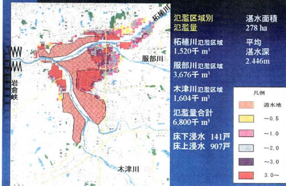
図 3-10 河床掘削後の氾濫計算結果 (昭和 40 年台風 24 号型洪水)
