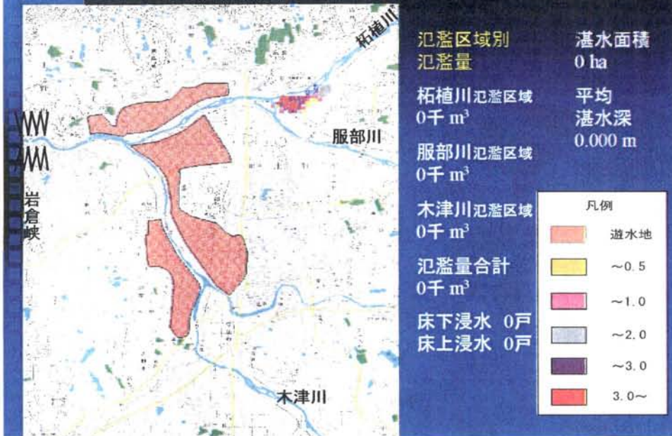
図 2-3 現況河道での氾濫計算結果（昭和 28 年台風 13 号型洪水）
