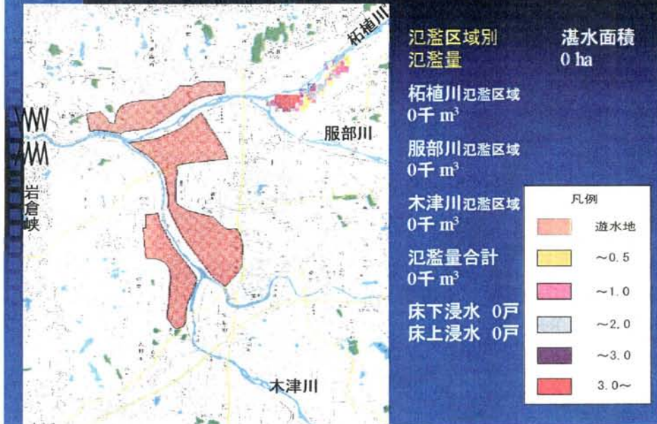
図 3-5 現況河道での氾濫計算結果 (昭和 28 年台風 13 号型洪水)
