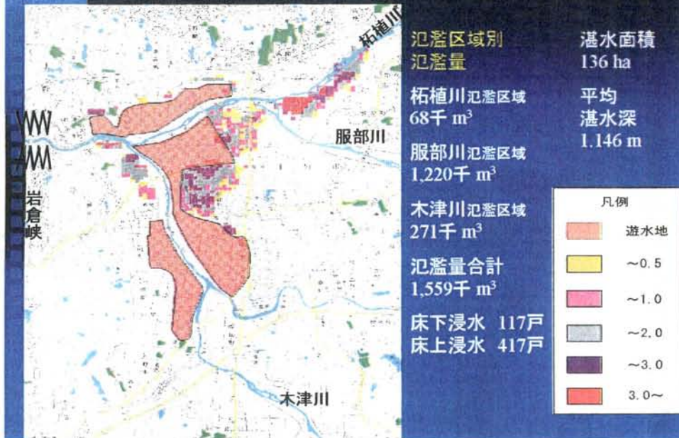
図 2-11 現況河道での氾濫計算結果 (昭和 40 年台風 24 号型洪水)
