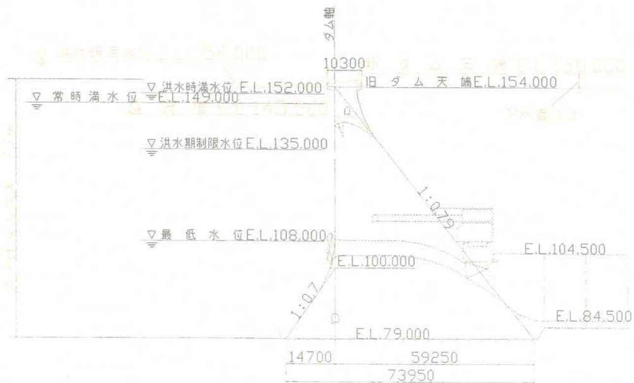
(2.0m 嵩上げ) ダム標準断面図
