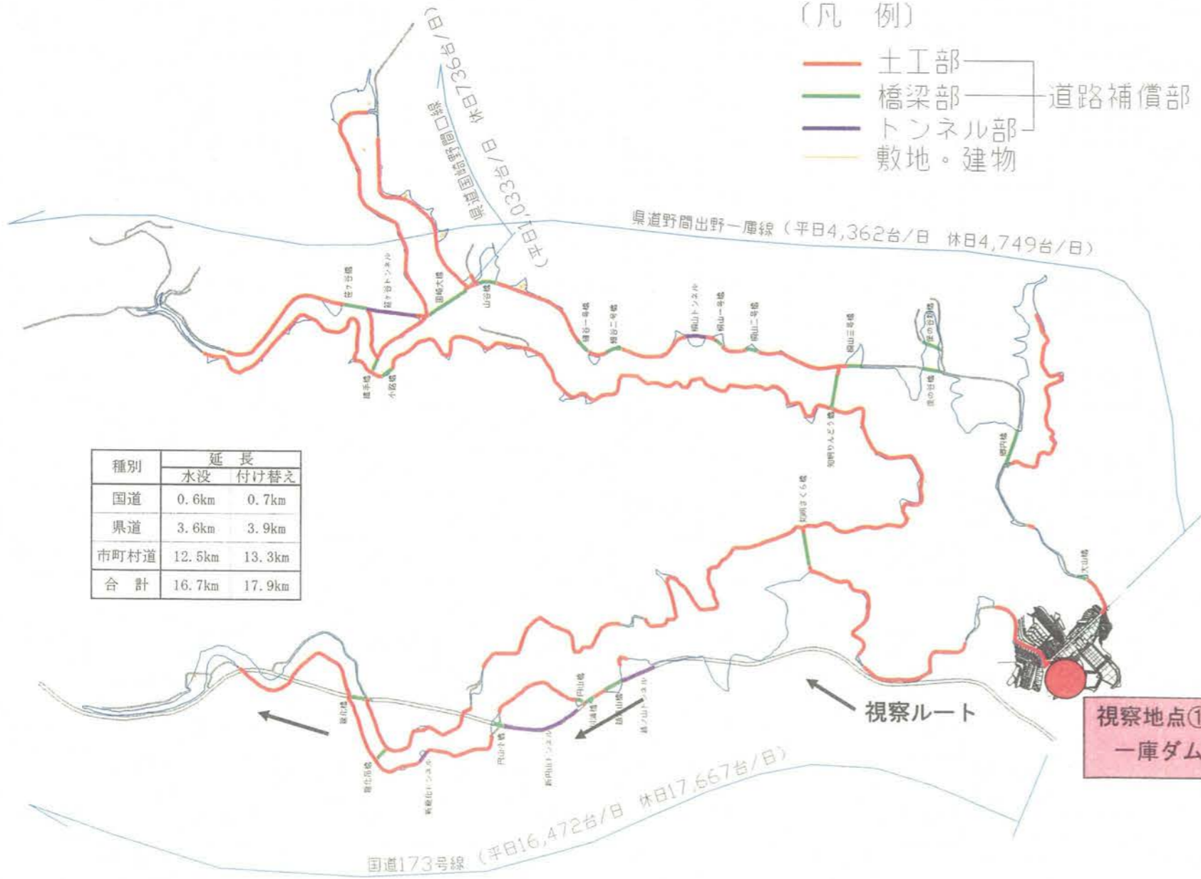
嵩上げに伴う補償工事（嵩上げ高 5.0m）
