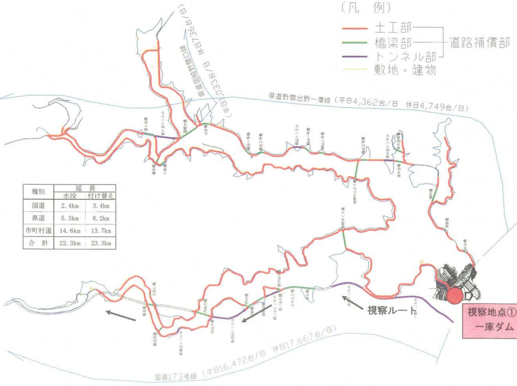
嵩上げに伴う補償工事 (嵩上げ高 10.0m)
