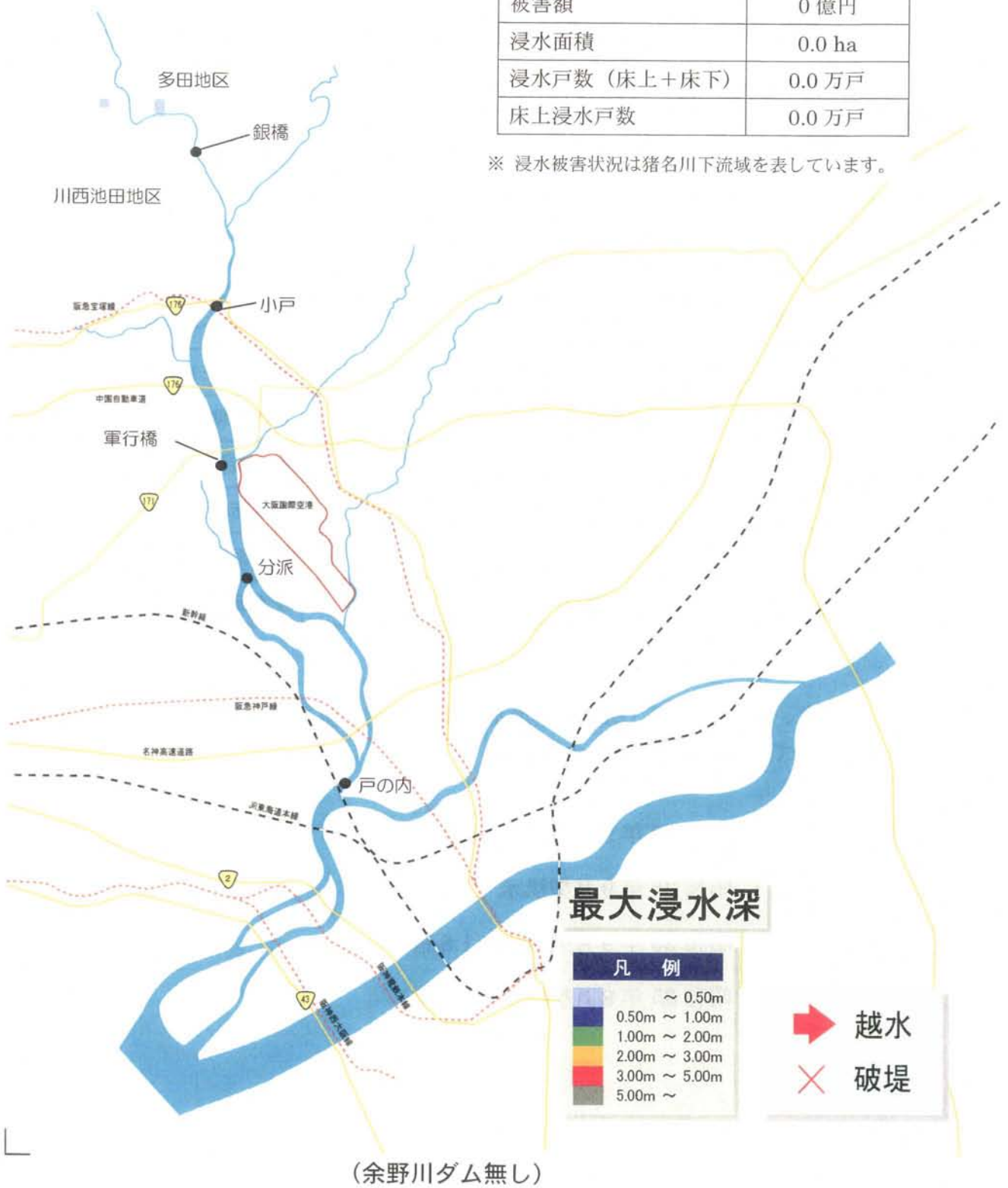
図-3.5 最大浸水深分布比較図 (昭和 28 年 9 月型 1.0 倍)
